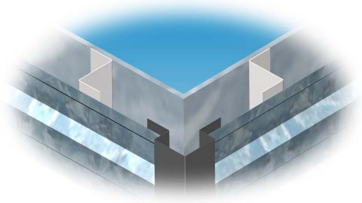
*II.3.e) Raccord d'angle sans recouvrement de bardage rentrant*
