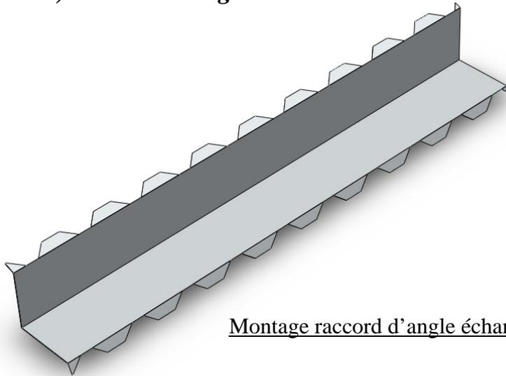
Montage raccord d'angle échancré rentrant
